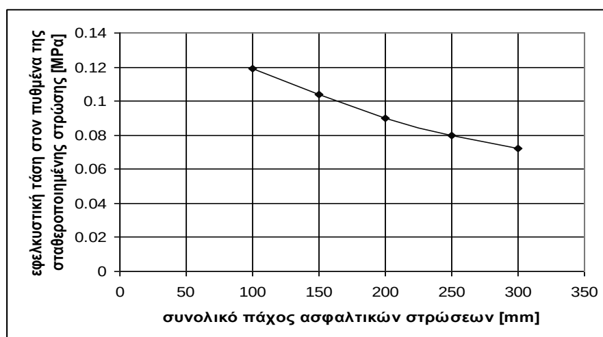
Σχ. 9: Αναπτυσσόμενες εφελκυστικές τάσεις στον πυθμένα της σταθεροποιημένης στρώσης για διάφορα συνολικά πάχη ασφαλτικών στρώσεων.
