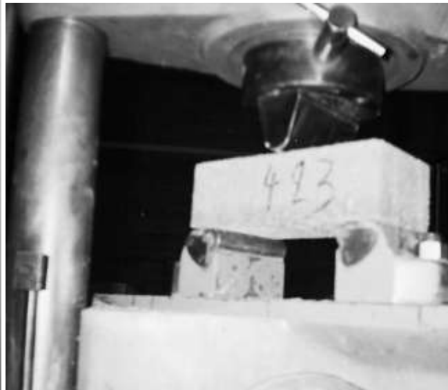
Εικόνα 12. Δοκιμή κάμψης σε κυβόλιθο
