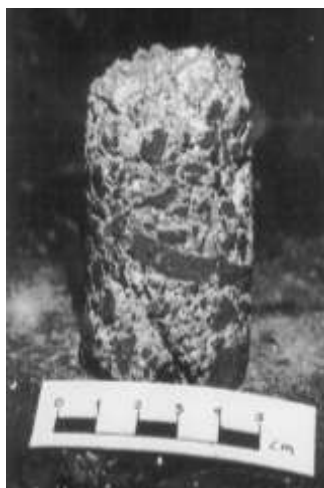
Εικόνα 1. Κεραμικά αδρανή σε κονίαμα από την Αγία Σοφία Θεσσαλονίκης (6 ος μ.Χ. αιώνας)
