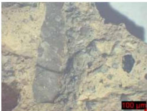
Σχήμα 5. Δομή σκυροδέματος με χρήση ανακυκλωμένων αδρανών (x8)
