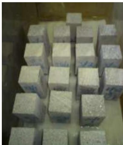
Εικόνα 7. Μέτρηση διείσδυσης χλώριο-ιόντων μέσω τριχοειδούς ανύψωσης
