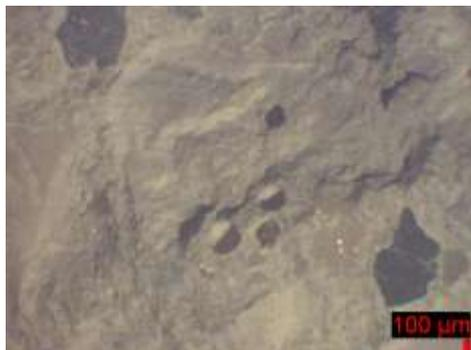
Σχήμα 4. Δομή σκυροδέματος με χρήση αδρανών λατομείου (x8)
